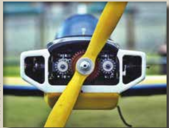
Voici une vue de devant du Dalotel de Prettner de 1978: on remarque les engrenages qui accouplent les deux moteurs monocylindres.
