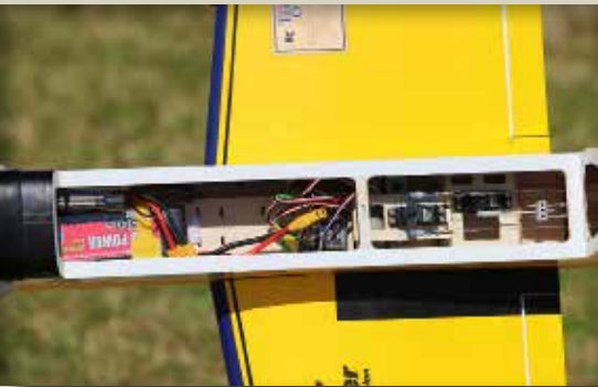
Le large cockpit amovible procure un accès facile aux équipements. En dessous, la longue platine permet d'avancer et de reculer l'accu, autorisant un ajustage sans plomb du centrage.
