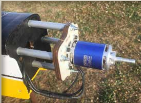
Le moteur Boost 40 V2 est fixé sur un bâti en contreplaqué, lui-même solidaire de la cellule grâce à des vis et colonnettes.
