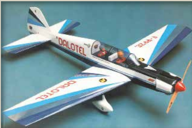
Le large cockpit amovible procure un accès facile aux équipements. En dessous, la longue platine permet d'avancer et de reculer l'accu, autorisant un ajustage sans plomb du centrage.
